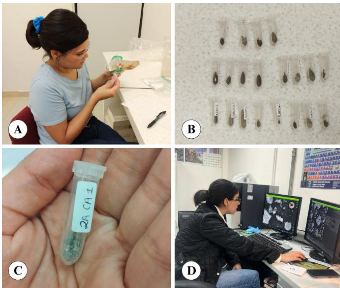
Figura 6. A) Vertimiento de partículas con micro tubo; B) Micro tubos con partículas C) Micro tubo con partículas etiquetado con clave de las especies de estudio; D) Análisis de partículas en SEM-EDS. Fuente: Fotografías propias tomadas en agosto de 2023 y enero de 2025 en Laboratorio de Posgrado-UES y Laboratorio de Geoquímica-UNISON.
