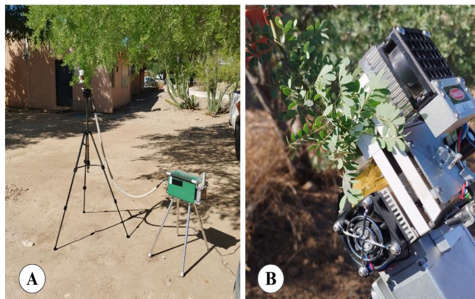
Figura 10. A) Instalación del equipo medidor de gases B) Medición de CO 2 en árbol de adulto de O. tesota . Fuente: Fotografías propias tomadas en octubre de 2023 en CIAD.
