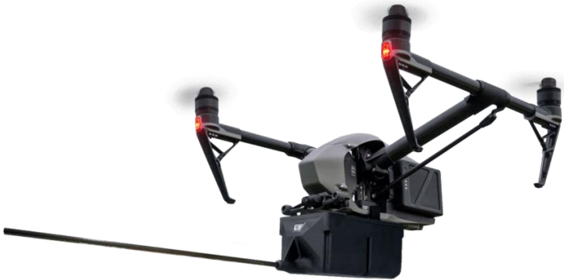
Figura 4. Laboratorio aéreo DR2000 instalado en un dron DJI® Inspire 2.
