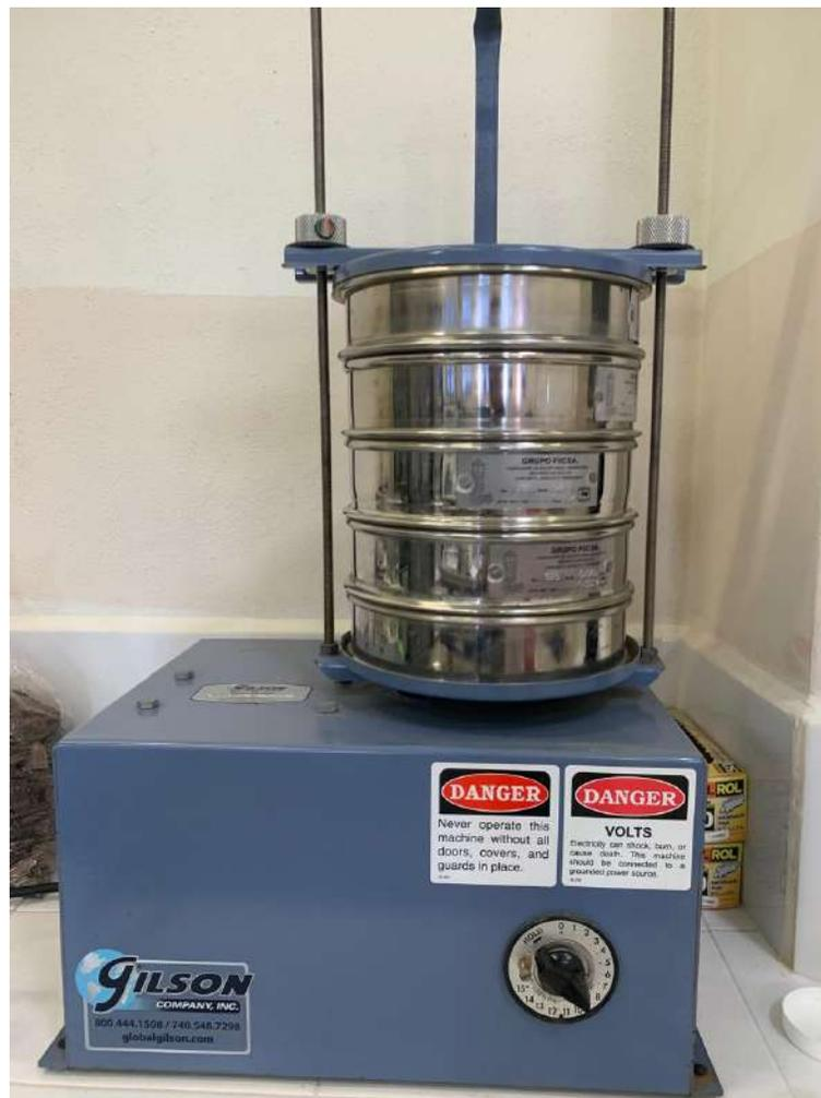
Figura 19. Proceso de tamizaje con los tamices respectivos. **Fuente:** Imagen propia.
